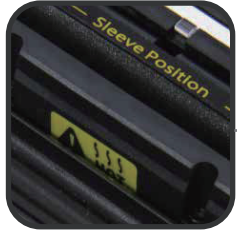
Le temps de soudage est de 9 secondes Temps de chauffage est de 20 secondes
